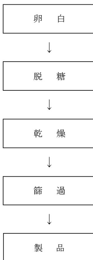
※ 本資料は、出発原料から製品までどのように製造されるかを記載した工程図（参考情報）です。
