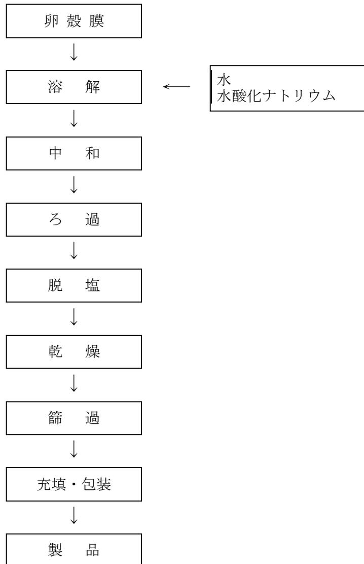
※ 本資料は、出発原料から製品までどのように製造されるかを記載した工程図（参考情報）です。
